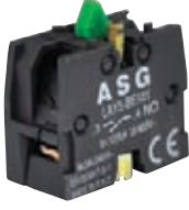
YEDEK KONTAK 3A / 240 V AC, IP 44
