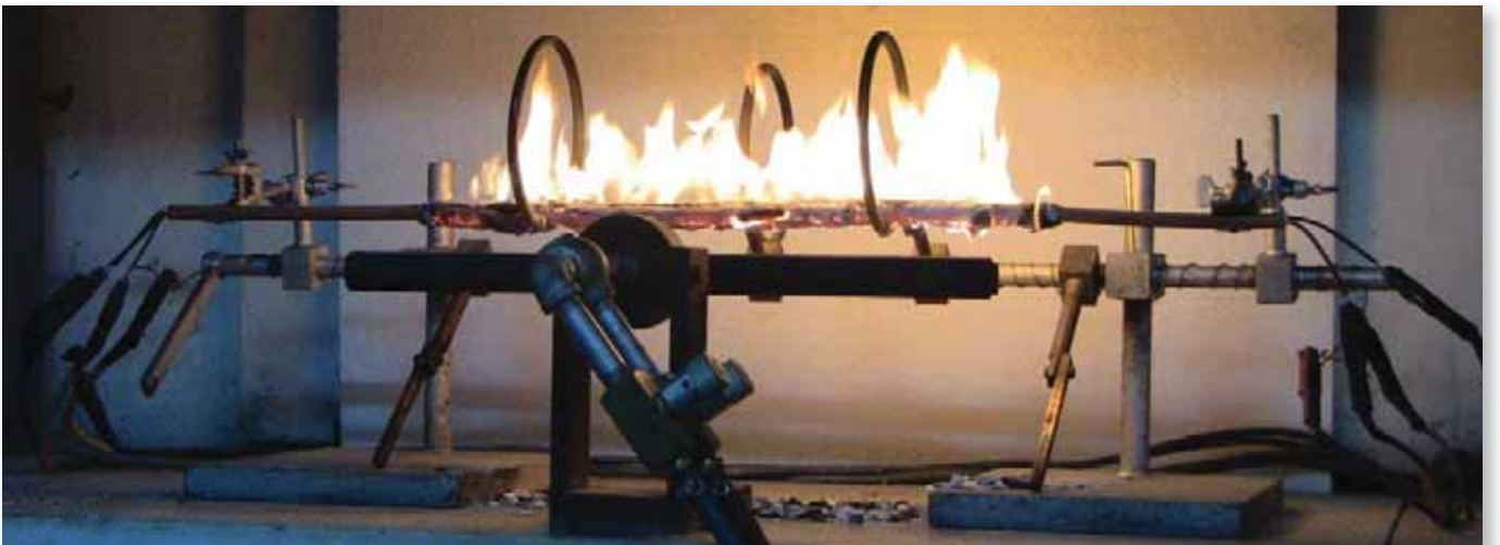
Gerilim altında yanma testindeki bir kablo numunesi.
