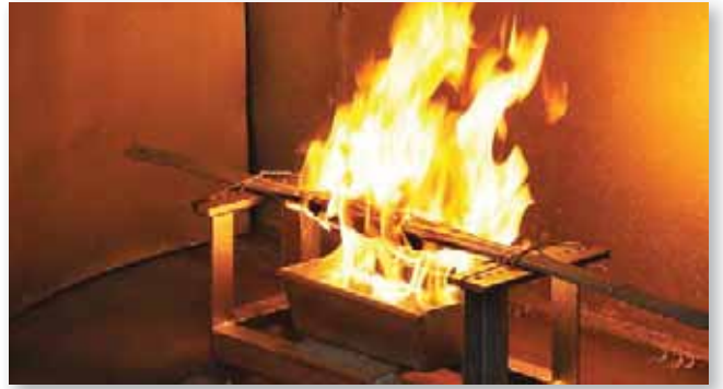
Duman yoğunluğu testinde, yakıt standartlardaki ölçülerde konulmalıdır.
