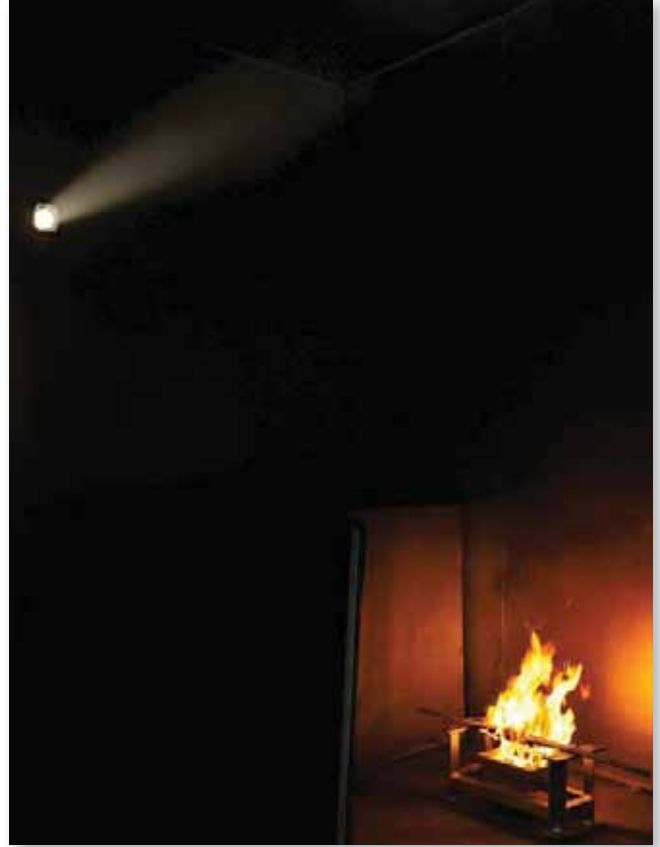
Duman yoğunluğu testindeki bir kablo numunesi.
