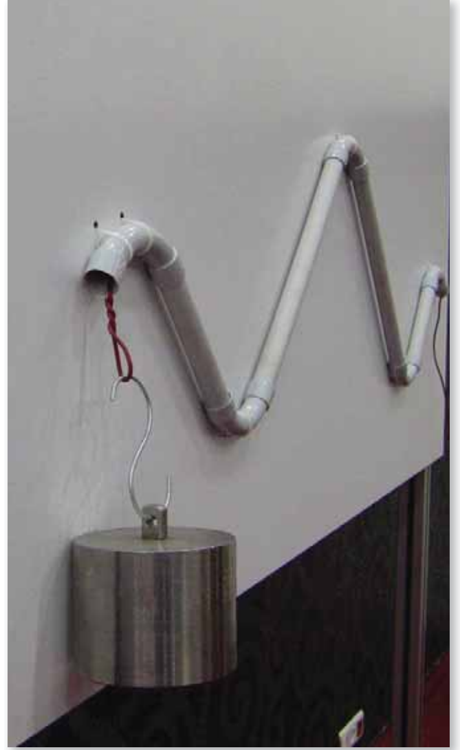
Kaygan kablolar düşük miktardaki kuvvetlerde bile boru içerisinde rahatlıkla hareket ederler.
