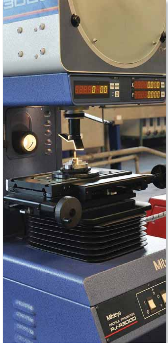
Profil projektör ile geometrik ölçümler yapılır.
