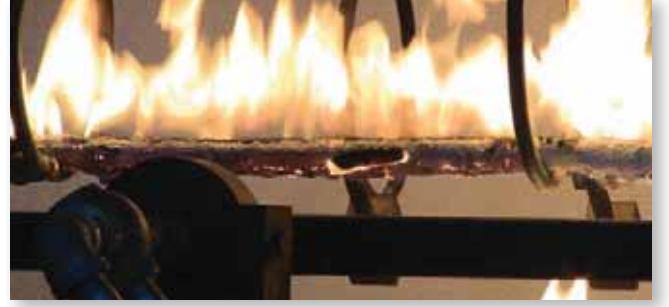
Test esnasındaki bir kablo, 3 saat boyunca gerilim taşımaya devam etmelidir.
