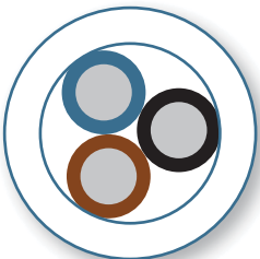
Dış kılıf et kalınlığı için kesit görünümü.
