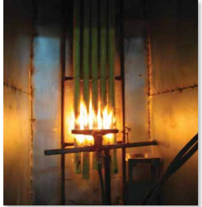
Demetlenmiş kabloların yanması testindeki bir kablo numunesi.
