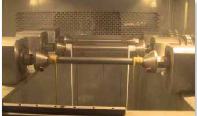
Döngüsel dayanım testindeki kablo numuneleri.
