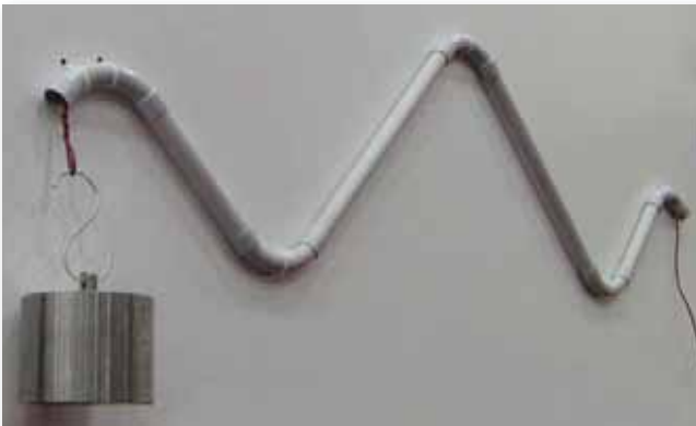
Kayganlık testindeki bir test numunesi.
